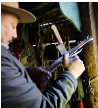
Fotografía 9. Arnulfo Trncoso cortando tientos solo con cuchillo a manera tradicional
