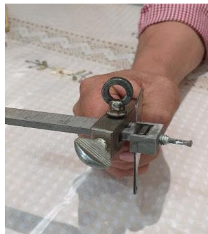
Fotografía 20. Arnulfo Trncoso, de Cochrane, con herramienta que adquirió en el extranjero. Es el único que ha comprado una herramienta para cortar los tientos.
