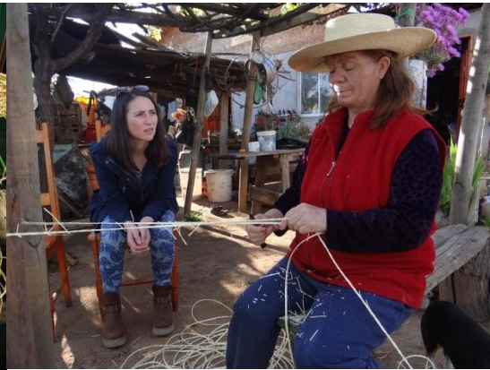
FIGURA N° 4 LIMPIEZA DE CUELCHA PARA LA FABRICACIÓN DE CHUPALLAS
