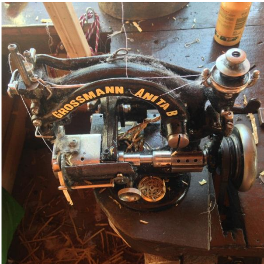
FIGURA N° 5 MÁQUINA MODELO GROSSMANN PARA COSER CHUPALLAS
