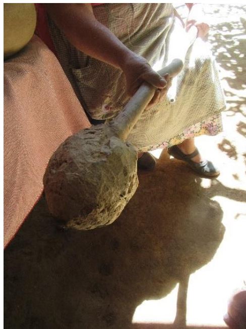
Fotografía 17. Mazo artesanal de madera, para machacar la tierra.
