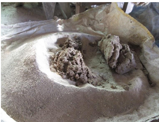
Fotografía 18. Arcilla molida en proceso de amasado, para formar la pasta cerámica.
